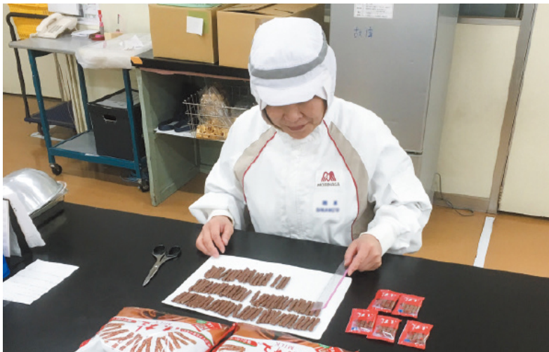
製品検査（製品の規格に合っているか長さや重さを測定）
